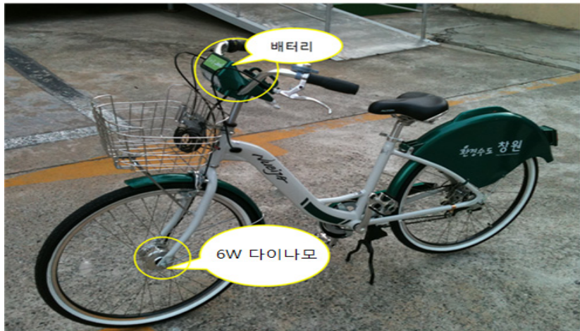
그림4 <배터리와 다이나모가 부착된 공영자전거>
